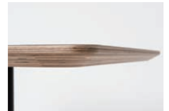
28 mm Multiplex mit HPL, Kante 10 mm gerade und dann 60° abgeschrägt, „Schweizer Kante“
