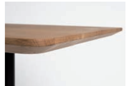
27 mm und 35 mm Tischplatte abgeplattet, Schmalfläche 60°, Eckenradius 36 mm, „Schweizer Kante“
